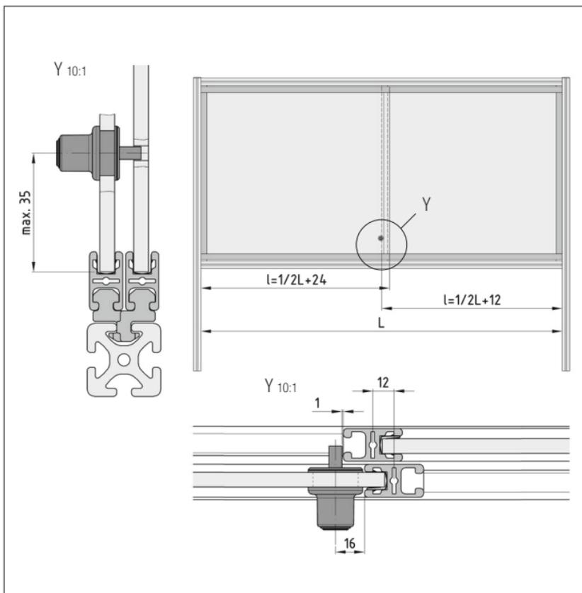
Aufbau einer Schiebetür bei Verwendung des Schiebetür-Führungssatzes 8
