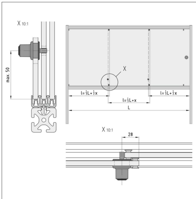
Aufbau einer Schiebetür bei Verwendung des Schiebetür-Führungssatzes 8/8
