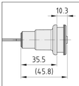
Einbaumaße im verriegelten und geöffneten Zustand.
