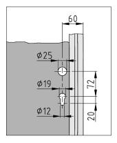
Das Schlossgehäuse und, wenn erforderlich, das Flächenelement müssen mit den Durchführungsöffnungen für Türdrücker und Profilzylinder versehen werden.
