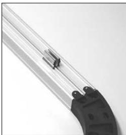
Aufschieben der Klipps 8 auf das Rollladen-Führungsprofil, empfohlene Anzahl 5 Stück pro Meter.
