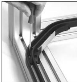
Die Rollladen-Kurvenführung oder das Verbindungselement können bei Bedarf mit Halbrundschräuben M4x12 am Trägerprofil verschraubt werden.
