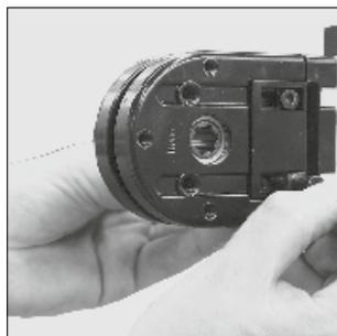
Die Kette wird an der zuvor bearbeiteten Stelle in das Kettenführungsprofil eingeführt. Mit einem Dorn kann das erste Kettenglied durch die Führung und in die Kettenumlenkungen gezogen werden.
