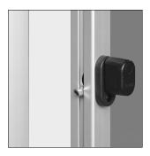
Der Schwenkriegel-Verschluss kann mit bis zu zwei Stangenverschlüssen erweitert werden, um eine bessere Absicherung der Tür zu gewährleisten. Die Betätigungsstangen werden innerhalb der Kernbohrung des Türprofils jeweils zu den Stangenverschluss-Riegeln geführt. Bei Verwendung von zwei Stangenverschlüssen besteht auch die Möglichkeit, auf den Schwenkriegel zu verzichten und das Schloss ausschließlich als Stangenschloss zu betreiben.
