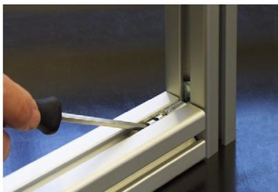
Zylinderschrauben mittels Kugelkopf-Schraubendreher durch die Automatikverbinder stecken und in die Nutensteine einschrauben.
