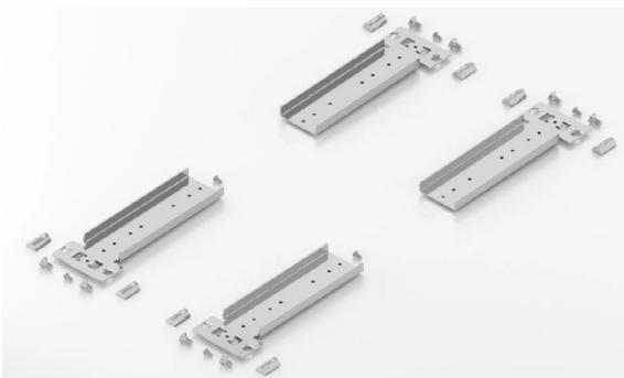
Der Montagesatz wird mit Senkschrauben DIN 7991 M6x12 in den Nuten der Profile der Baureihe 8 40x40 oder 8 80x40 befestigt
