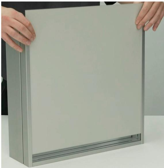
In diese U-Form wird die zugesägte Fläche **5** in die dafür vorgesehene Nut in den Rahmenprofilen eingeschoben.
