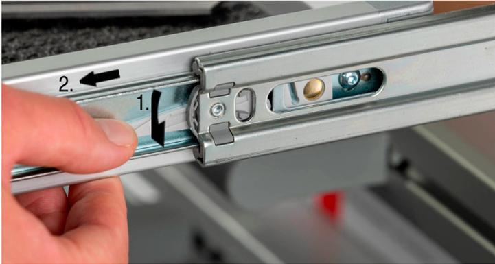
Um die Teleskopschienen zu befestigen, trennt man zunächst die Außenschiene von der Innenschiene. Kunststoffhebel bewegen (1.) und anschließend Innenschiene herausziehen (2.).
