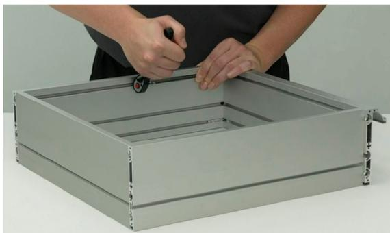
Die Schublade wird mit dem Schubladensystem, Frontprofil mit Griffleiste **2** geschlossen. Die Fläche **5** ragt dabei in die dafür vorgesehene Nut des Frontprofils. Anschließend alle Verbinder fest verschrauben.
