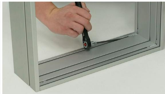
Zunächst werden die Automatikverbinder (Bestandteil des Automatik-Verbindungssatzes 6 **7**) an den vorgesehenen Positionen in die Nut der Schubladensystem, Rahmenprofile **6** und **8** bündig eingeschraubt.
