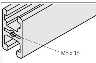
Alle Klemmprofile 8 32x18 werden mit einem Gewinde M5x16 an den Profilen versehen
