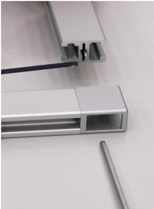
Die Klemmprofile 8 32x18 werden mit den Klemmprofil-Eckverbindingssatz 8 32x18 (0.0.494.73) zu einem Rahmen verbaut, die Fläche wird dabei umschlossen. Das Klemmprofil 8 32x18 hat zwei unterschiedliche Nuten, achten Sie darauf die Profilmuten wie im Bild dargestellt anzuordnen.
