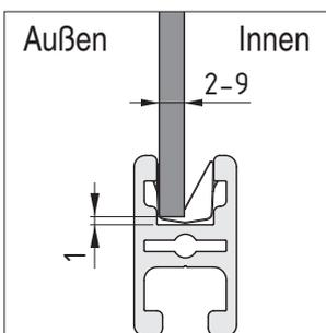
Optional kann das Flächenelement in der speziellen Nut des Profils mit Hilfe von Klemmfedern (0.0.406.21) gehalten werden.
