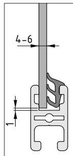
Anschließend wird die Fläche liegend mittig im Rahmen ausgerichtet und mit dem Dichtprofil (0.0.489.91) eingefasst.
