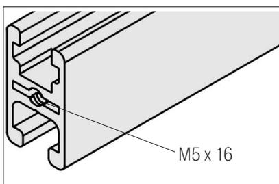
Alle Klemmprofile 8 32x18 werden mit einem Gewinde M5x16 an den Profilenenden versehen
