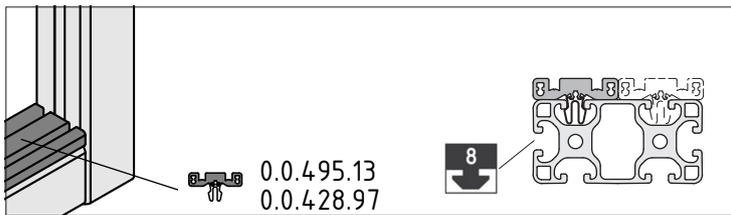
Die Klipps 8 St (0.0.428.97) werden im Abstand von ca. 200mm auf die Schiebetürprofile (0.0.495.13) gefädelt und anschließend von Hand in die Nutgeometrie der Baureihe 8 gedrückt.
