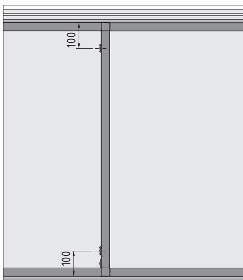
Die Nutensteine sind bereits positioniert. Ca. 100mm von der Schiebetür-Oberkante und -Unterkante werden die Mitnehmer befestigt.
