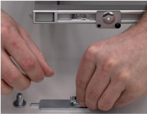
Die Verdrehsicherung wird in die Fixierung eingesetzt.
