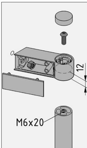
Das Profil D25 (0.0.601.23) bekommt an beiden Profilenden ein Gewinde M6x20.
