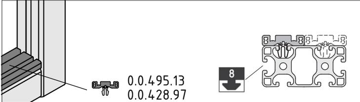
Die Klipps 8 St (0.0.428.97) werden im Abstand von ca. 200mm auf die Schiebetürprofile (0.0.495.13) gefädelt und anschließend von Hand in die Nutgeometrie der Baureihe 8 gedrückt.
