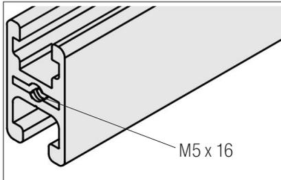
Alle Klemmprofile 8 32x18 werden mit einem Gewinde M5x16 an den Profilen versehen
