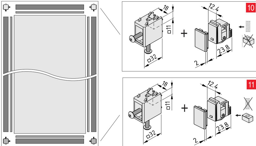
Die Rollensätze für Eckverbinder 8 32x18 (0.0.494.74) werden nun in die bereits montierten Klemmprofil-Eckverbindungsätze 8 32x18 (0.0.494.73) eingeschoben, die oberen mit Feder, die unteren mit Fixierblock.
