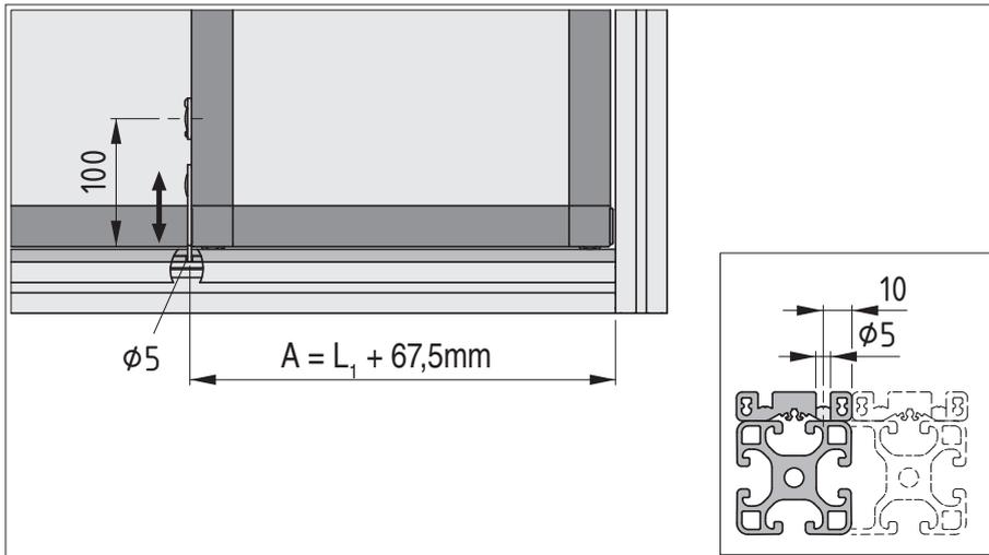
Das Schiebetür-Führungsprofil 8 40x10 wird mit zwei Bohrungen für die Fixierung versehen.
