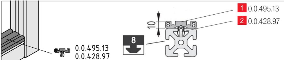
Die Klipps 8 St (0.0.428.97) werden im Abstand von ca. 200mm auf die Schiebetürprofile (0.0.495.13) gefädelt und anschließend von Hand in die Nutgeometrie der Baureihe 8 gedrückt.
