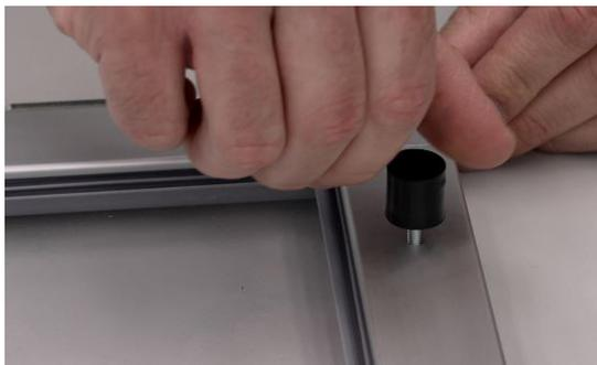
Der Anschlagpuffer D15x15 M4x12 (0.0.416.33) wird handfest im Innenbereich der Schiebetür befestigt.
