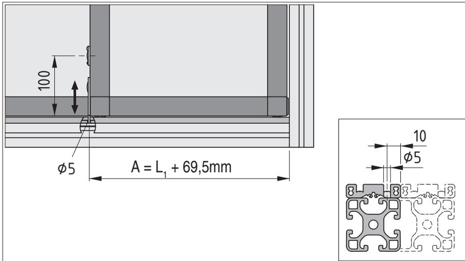
Das innenliegende Schiebetür-Führungsprofil 8 40x10 wird mit einer Bohrung für die Fixierung versehen.
