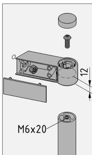
Das Profil D25 (0.0.601.23) bekommt an beiden Profilenden ein Gewinde M6x20.
