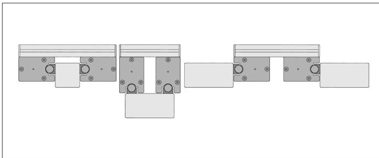
Die Laufrollenprofile bieten variable Befestigungsmöglichkeiten über Nuten der Baureihe 8, wodurch sich die Montage und das Ausrichten auf Profilen oder Aufspannplatten wesentlich vereinfacht.
