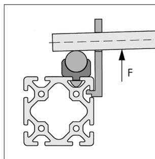
Bei längeren Strecken, deren Trägerprofile bereits montiert sind oder z. B. im Schraubstock gehalten werden, kann nach dem Eindrücken des Wellenklemmprofils die Welle unter Zuhilfenahme des Montagewinkels (Best.-Nr. 0.0.265.38) und eines entsprechenden Rundstahls als Hebel abschnittsweise in das Wellenklemmprofil eingepresst werden.
