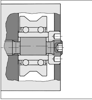
Die exzentrischen Lagereinheiten müssen vor dem Einsetzen des Führungswagens bezüglich ihrer Exzenterlage vorbereitet werden.
