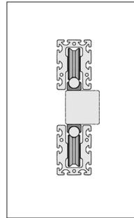
Zum Aufbau einer Linearführung werden grundsätzlich zwei zentrische (feste) und gegenüber zwei exzentrische (einstellbare) Lagereinheiten benötigt. Zwei einzelne Lagereinheiten können auch durch je eine Doppellagereinheit ersetzt werden. Bei Bedarf können auch entsprechend mehr Lagereinheiten eingesetzt werden.
