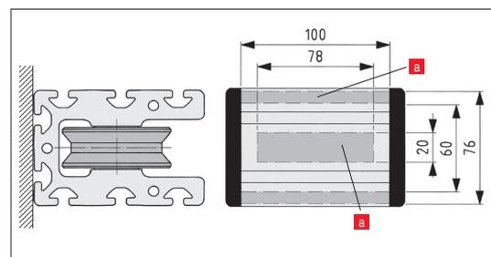
**a** Bereich bzw. Bohrung für Zylinderstift DIN 7979-6x32
