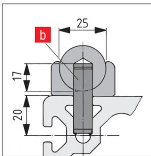
Bei höheren Belastungen empfiehlt sich ein Festsetzen der Welle. Die Bearbeitung von Welle, Wellenklemmprofil und Trägerprofil erfolgt vorzugsweise mittels Kombi-Bohrlehre
