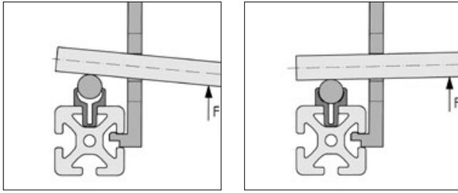
Bei längeren Strecken, deren Trägerprofile bereits montiert sind oder z. B. im Schraubstock gehalten werden, kann nach dem Eindrücken des Wellenklemmprofils die Welle unter Zuhilfenahme des Montagewinkels (Best.-Nr. 0.0.265.38) und eines entsprechenden Rundstahls als Hebel abschnittsweise in das Wellenklemmprofil eingepresst werden.
