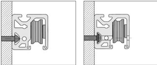
Bei höheren Belastungen empfiehlt sich ein Festsetzen der Welle. Die Bearbeitung von Welle, Wellenklemmprofil und Trägerprofil erfolgt vorzugsweise mittels Kombi-Bohrlehre **c** in folgenden Schritten:
