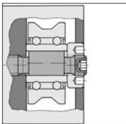
Die exzentrischen Lagereinheiten müssen vor dem Einsetzen des Führungswagens bezüglich ihrer Exzenterlage vorbereitet werden.
