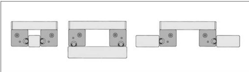
Die Laufrollenprofile bieten variable Befestigungsmöglichkeiten über Nuten der Baureihe 8, wodurch sich die Montage und das Ausrichten auf Profilen oder Aufspannplatten wesentlich vereinfacht.
