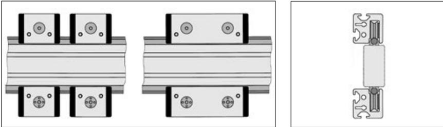
Zum Aufbau einer Linearführung werden grundsätzlich zwei zentrische (feste) und gegenüber zwei exzentrische (einstellbare) Lagereinheiten benötigt. Zwei einzelne Lagereinheiten können auch durch je eine Doppellagereinheit ersetzt werden. Bei Bedarf können auch entsprechend mehr Lagereinheiten eingesetzt werden.
