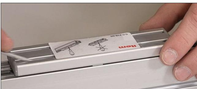
Nachdem der Schlitten in das Profil eingeschoben worden ist, wird das Sicherheitsetikett entfernt. Das Spiel des Schlittens im Profil ist noch deutlich spürbar.
