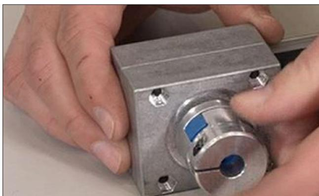
Der Kupplungszahnkranz und anschließend die Kupplungshälfte D30/D12 wird auf die Spreiznabenkupplungshälfte bündig aufgesteckt. Die Klemmschraube der Kupplungshälfte D30/D12 sollte, wie im Bild zu sehen ist, ausgerichtet werden und von oben erreichbar sein.
