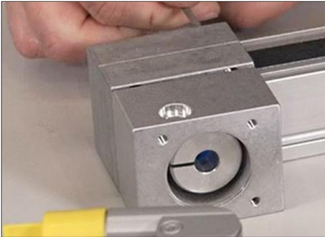
Jetzt wird das Kupplungsgehäuse aufgesteckt und mit den Zylinderschrauben M4x45, liegen dem Antriebssatz bei, durch das Gehäuse des Zahnriemenantriebs in das Kupplungsgehäuse des Antriebssatzes geschraubt.
