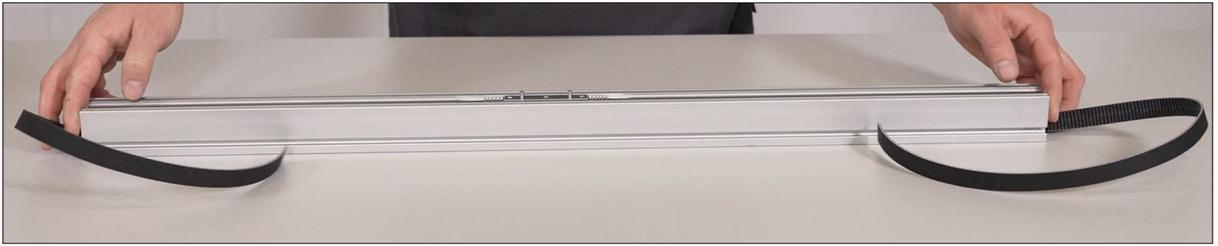
Um die Filze der Schlitteneinheit zu schmieren wird zunächst der Zahnriemen entspannt. Dazu die Spannachse der Umlenkung durch abwechselndes drehen der Spannschrauben zum Schlitten bewegen. Die Schlittenplatte sowie die Bleche werden anschließend demontiert. Der Zahnriemen wird abgenommen, so dass die Filze mit einer Ölkanne erreicht werden können (Pressol-Ölkanne KLE-LR, Art.-Nr. 0.0.612.74)
