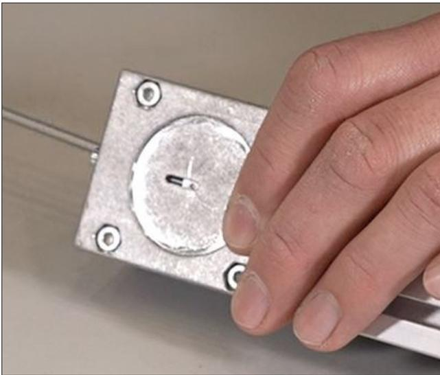
Um den Schlitten mit dem Zahnriemen zu verbinden wird zunächst die Spannrolle der Umlenkung zurückgestellt.
