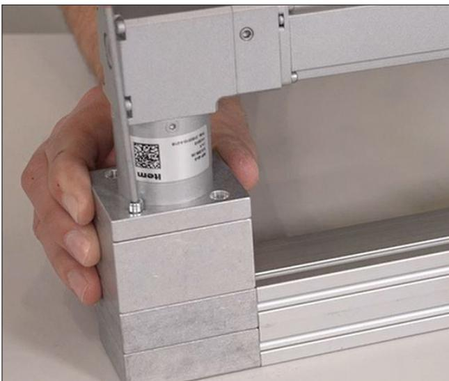
Der abgebildete Motor SE 40 mit dem Getriebe WP 40 wird in den Antriebssatz gesteckt und mit den vier Schrauben M4x10 fest verschraubt.
