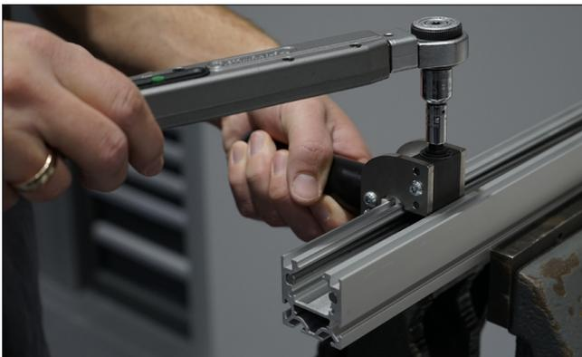
In 40mm Schritten wird die Welle auf der kompletten Profillänge in den Kanal gepresst.
