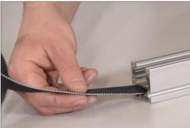
Der bereits auf die berechnete Länge zugeschnittene Zahnriemen wird im unteren dafür vorgesehenem Bereich des Profils eingeschoben. Der Rücken des Zahnriemens weist dabei nach unten, die Zähne sind nach innen ausgerichtet.
