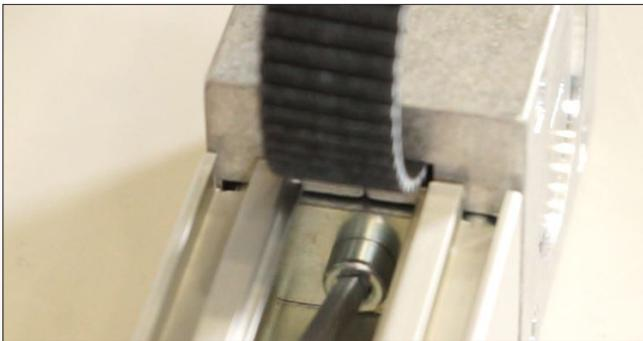
Die Umlenkung wird nun bis an das Profil herangezogen und von innen am Profil mit der Zylinderkopfschraube M5x12 befestigt.
