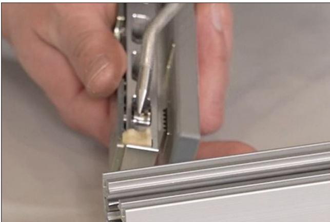
Die Filze des Abstreif- und Schmiersystem werden vor der Montage ausreichend mit Öl benetzt
