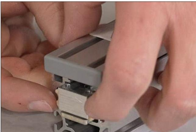
Die Filze des Abstreif- und Schmiersystem werden beim Einführen des Schlittens in das Trägerprofil vorsichtig zusammengedrückt, um an den scharfen Sägekanten des Profils nicht beschädigt zu werden.
