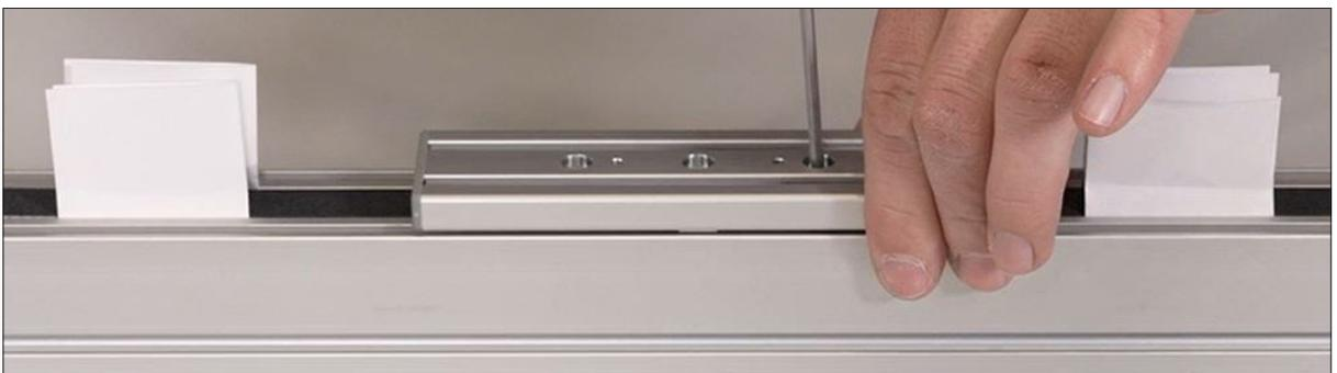
Die drei Zylinderkopfschrauben M4x25. mit der Schlittenplatte auf den Blechen verschrauben.
