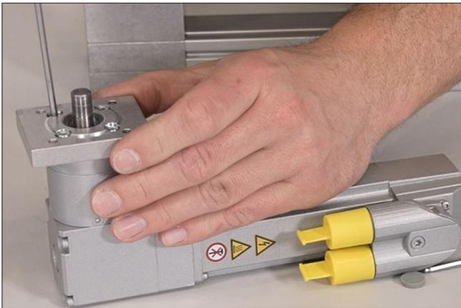
Anschließend wird die Adapterplatte für den Motor SE 40, mit Hilfe der vier Zylinderkopfschrauben M4x12, ebenfalls bündig zum Kupplungsgehäuse festgeschraubt.
