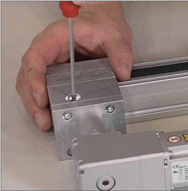
Zum Schluss wird die Klemmnabenschraube M3 der Kupplungshälfte D30/D12 durch die Wartungsbohrung angezogen. Die Bohrung wird durch eine Kappe verschlossen.
