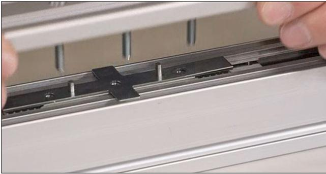
Die nun zugänglichen Zylinderkopfschrauben werden gelöst. Die vorgespannte Feder beginnt sich zu entspannen und justiert dabei die beiden inneren Laufrollen spielfrei im Profil. Durch leichte Bewegung des Schlittens wird die spielfreie Einrichtung unterstützt. Verfahren Sie den Schlitten über die komplette Profillänge und prüfen Sie die Spielfreiheit. Im Anschluß werden die Zylinderkopfschrauben komplett gelöst und die Schlittenplatte entfernt.
