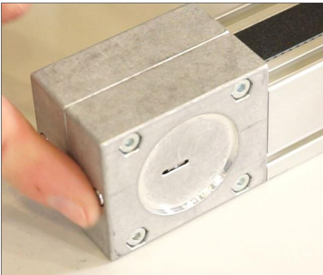
Ist die Kopffläche der Zylinderkopfschrauben bündig mit der Aussenfläche des Umlenkungsgehäuses ist der Zahnriemen ausreichend gespannt.
