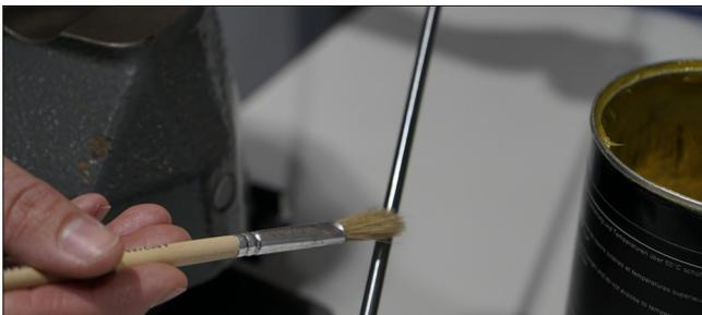
Die Welle wird mit einem handelsüblichen Wälzlagerfett benetzt, um das Einpressen zu erleichtern.
