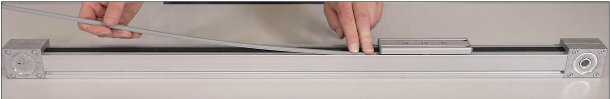
Zur Montage wird das bereits auf die richtige Länge zugeschnittene Abdeckprofil unter dem Schlitten durchgeschoben und anschließend in die Nut gedrückt. Dazu sollte sich der Schlitten in der Nähe einer Umlenkung befinden um das Abdeckprofil nicht eine zu weite Strecke schieben zu müssen.
