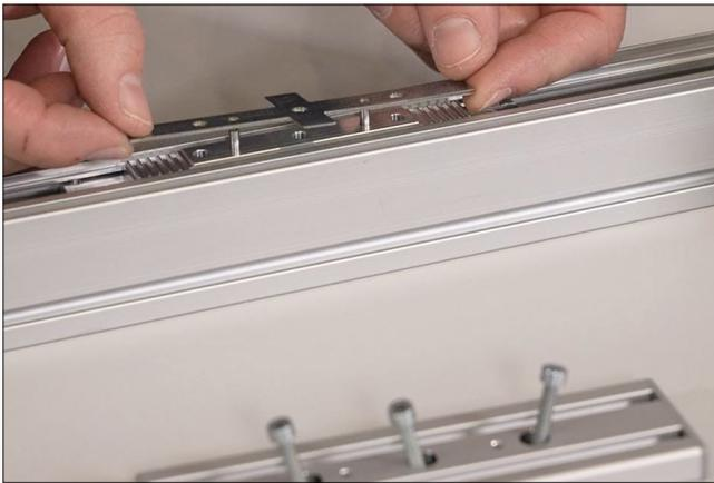
Unter der Schlittenplatte befinden sich zwei Bleche. Beide Bleche müssen entfernt werden. Lediglich die Zylinderstifte verbleiben im Schlittengrundkörper.
