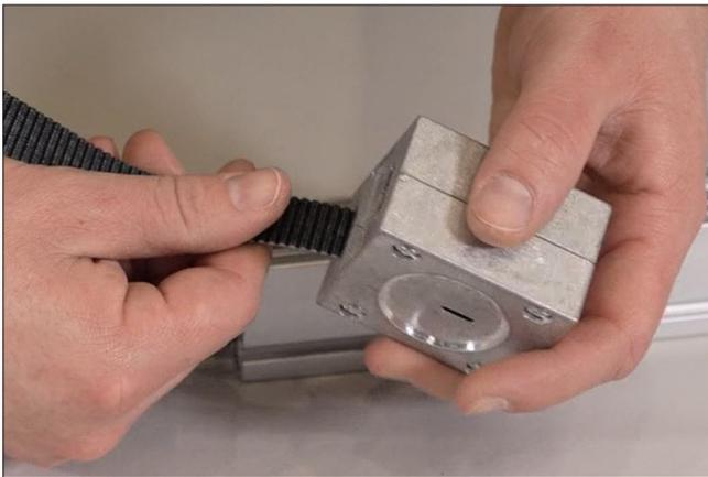
Der Zahnriemen wird zunächst unten mit den Zähnen nach innen in die Umlenkung eingeschoben bis er oben an der Umlenkung wieder austritt.
