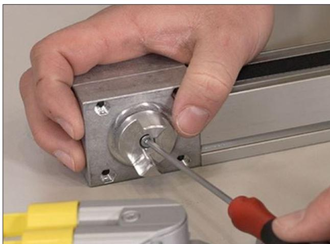
Die Spreiznabenkupplungshälfte wird in die Bohrung D12 der Lineareinheit gesteckt und die Spreiznabenschraube festgezogen.
