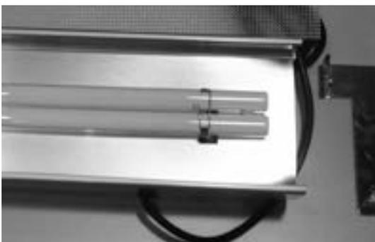
5. Im vorderen Bereich des Leuchtmittels ist dieses durch eine Federklammer fixiert. Diese Klammer muss vor dem Wechsel gelöst werden und nach dem Wechsel des Leuchtmittels wieder befestigt werden. Zum Lösen und späterem Befestigen wird die Federklammer aus- bzw. eingeschwenkt und verrastet.
