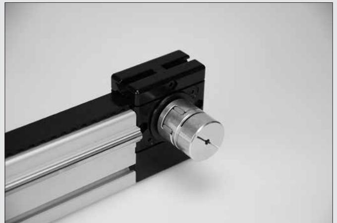
Über die gesamte Kupplung wird, mit Hilfe der Zylinderkopfschrauben DIN912 M6x45, M = 13 Nm, liegen dem Antriebssatz bei, das Kupplungsgehäuse des Antriebssatzes durch das Gehäuse des Zahnriemenantriebs verschraubt.
