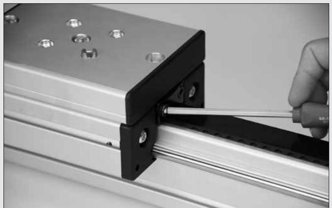
**⚠** Falls die LRE 8 D10 ZU 40 R25 komplett vormontiert geliefert wird, muss die Vorspannung entsprechend den Bestellvorgaben geprüft werden. Nach einer Einlaufzeit von 24h wird die Betriebsspannung des Zahnriemens erneut geprüft und bei Bedarf nachgespannt.
