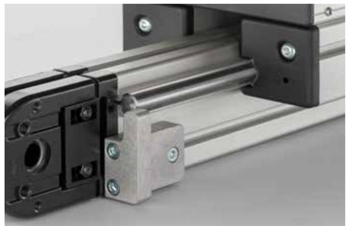
Zur Montage des Schlittenanschlags LRE 8 wird zuerst die gewünschte Endposition auf dem Trägerprofil der Linearachse markiert. Diese muss nicht dem maximal möglichen Hub entsprechen, sondern kann der Transportaufgabe entsprechend angepasst werden.
