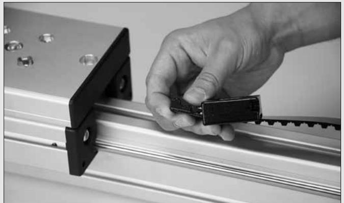
Der Zahnriemen wird an beiden Enden in die Spannböcke eingelegt, so dass alle Freiräume des Spannböcks belegt sind und anschließend fest verschraubt. Ein Spannböck wird unter der Schlittenplatte befestigt, der andere wird mit Hilfe der langen Zylinderkopfschrauben des in der Mitte befestigten Gegenlagers zum Spannen des Zahnriemens genutzt. Dazu werden beide Spannschrauben abwechselnd bewegt um ein gleichmäßiges Spannen zu gewährleisten.
