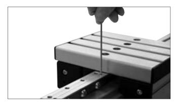
Es ist darauf zu achten, dass das Muttermitnahmesystem zur Spindel und zum Profil ausgerichtet ist. Die maximal zulässigen Winkelfehler dürfen nicht überschritten werden.
