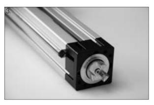
Anschließend wird die vorbereitete Spreiznabenkupplung mit der Zylinderkopfschraube M6x20, M = 13 Nm, in dem Antriebslagerblock der KGT verschraubt.
