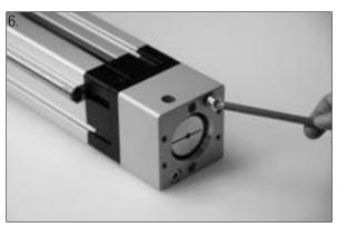
Durch die Öffnung im Kupplungsgehäuse kann die Klemmschraube der Kupplung bedient werden.
