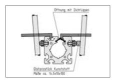
Bei höheren Belastungen empfiehlt sich ein Festsetzen der Welle. Die Bearbeitung von Welle, Wellenklemmprofil und Trägerprofil erfolgt vorzugsweise mittels Kombi-Bohrlehre c in folgenden Schritten:
