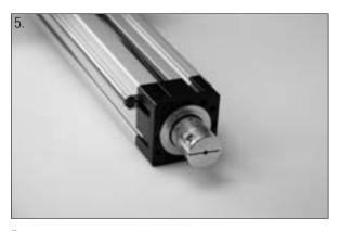
Über die komplett montierte Kupplung wird das Gehäuse geschoben und verschraubt, Zylinderkopfschraube DIN912 M8x60, M =  $25\,\mathrm{Nm}$ .
