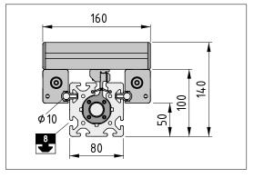
**Tipp:** Die Abstreif- und Schmiersysteme sind erst nach Abschluss der Einstellvorgänge zu montieren, da die Reibung der Filzabstreifer das notwendige Feingefühl zum Einstellen der Exzenterbolzen deutlich reduziert.
