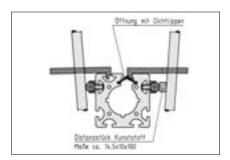
Bei längeren Strecken, deren Trägerprofile bereits montiert sind oder z.B. im Schraubstock gehalten werden, kann nach dem Eindrücken des Wellenklemmprofils die Welle unter Zuhilfenahme des Montagewinkels (Best.-Nr. 0.0.265.38) und eines entsprechenden Rundstahls als Hebel abschnittsweise in das Wellenklemmprofil eingepresst werden.
