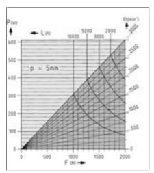
In Abhängigkeit von der Axialbelastung und den Antriebsdrehzahlen ist die Lebensdauerberechnung der Spindel-Flanschmutter-Kombination möglich.
