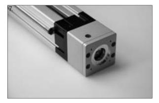
Ein Getriebe wird nicht benötigt. An der befestigten Adapterplatte wird anschließend der Motor mit den beigelegten Zylinderkopfschrauben DIN912 M4x16 (0.0.672.78) bzw. Zylinderkopfschrauben DIN912 M5x20 befestigt (0.0.672.77).
