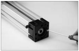
Die Antriebswelle überträgt das Antriebsmoment spielfrei. Dazu wird der Zentrierring ZR1 zwischen dem Lagerblock und der Adapterplatte positioniert. Anschließend werden die Halbrundschrauben ISO7380 M6x16, M = 13 Nm, liegen dem Antriebssatz bei, durch die Adapterplatte des Antriebssatzes in den Lagerblock des Kugelgewindetriebs geschraubt.
