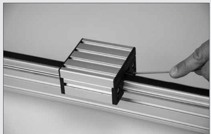
Die notwendige Zahnriemenspannung muss den erwartenden Belastungen entsprechend bestimmt und eingestellt werden.
