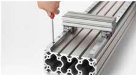
Nun muss der Schlittenaufbau fest montiert werden, der die Führungswagen der beiden Profilschienen mechanisch miteinander verbindet.
