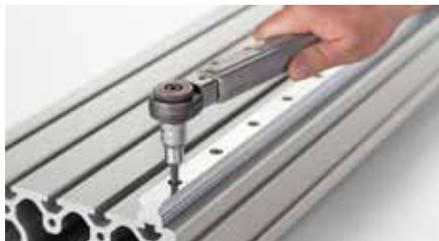
Die Profilschiene auf die Nut legen, die Hülsen zeigen dabei zur Nut. Dabei sollen die Bohrungen der Profilschiene genau mit den Bohrungen der Nutensteine fluchten.
