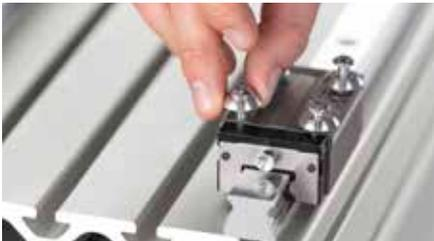
Die Nutzensteine aus den Befestigungssätzen in die Profilmutter einschwenken und mit dem passenden Abstand (60mm) ausrichten. Die zweite Profilschiene auf die Nut legen, die Hülse zeigt dabei zur Nut. Dabei sollen die Bohrungen der Profilschiene genau mit den Bohrungen der Nutzensteine fluchten.
