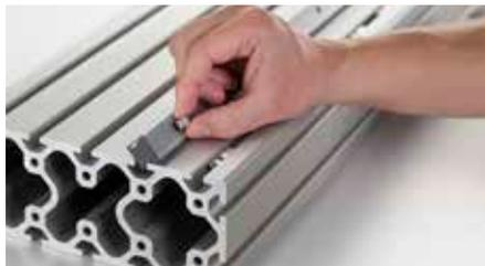
Anschließend die Montagehülsen in die Befestigungsbohrungen der Profilschiene bis zum Anschlag eindrücken.
