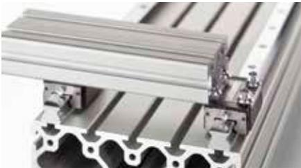
Die Befestigungsschrauben M5x18 in die Löcher der Profilschiene stecken. Alle Schrauben der Profilschiene von Hand anlegen und anschließend 1/2 Umdrehung wieder herausdrehen.
