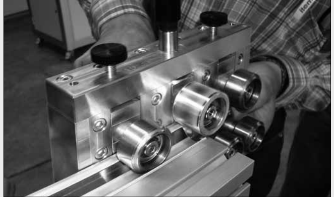
Einwalz-Montagewerkzeug bördelt die Aluminiumkanten um das Stahlband, erst oben dann Profil drehen und Vorgang wiederholen.
