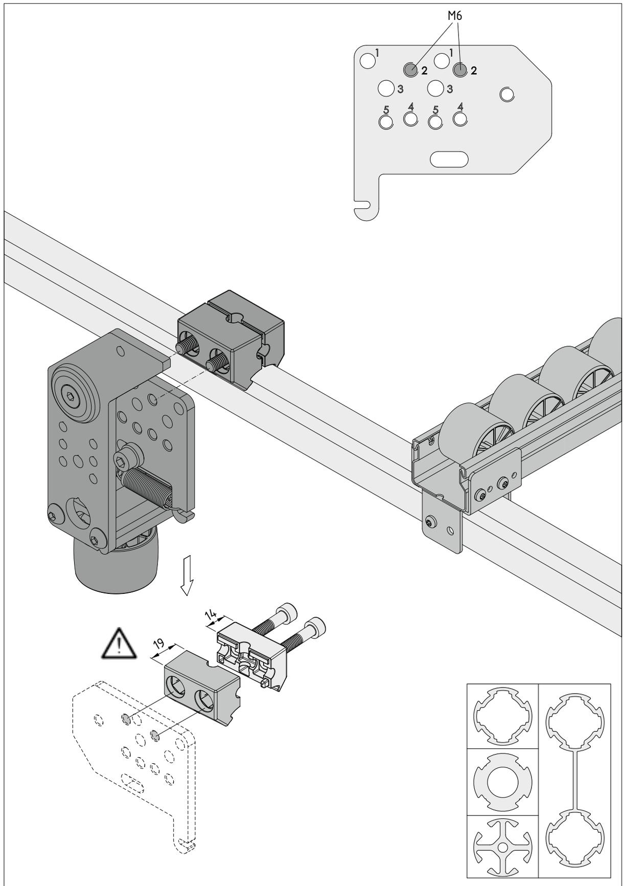
Variante - Rollenbahn St D30 - Befestigung mit Multiblock D30, Einbaulage unten
