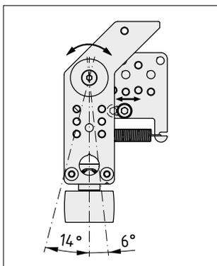
Der Freigaberiegel ist in einem Schwenkbereich von ca. 20° einstellbar
