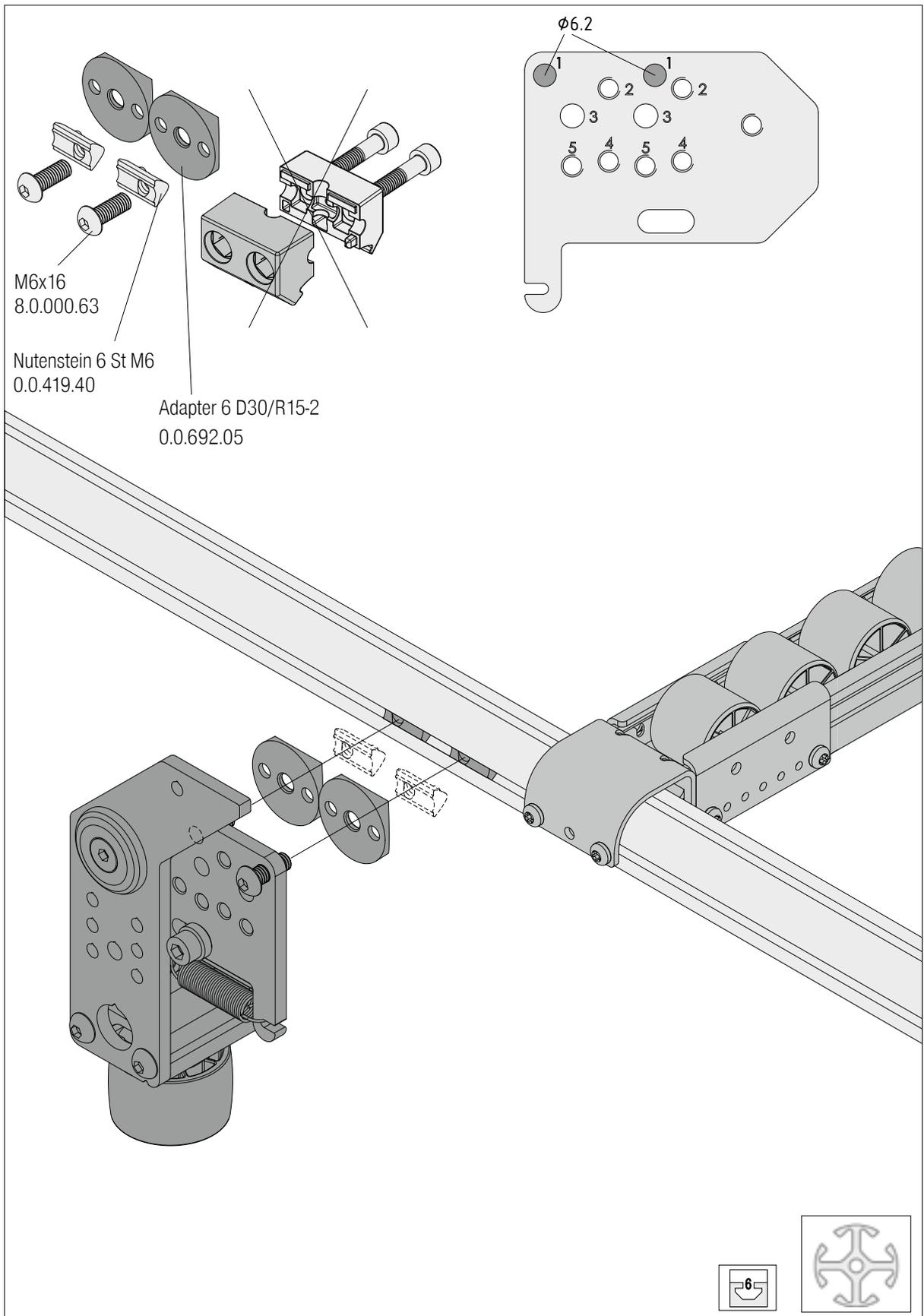
Variante - Rollenbahn St D30 - Befestigung mit Multiblock D30, Einbaulage oben
