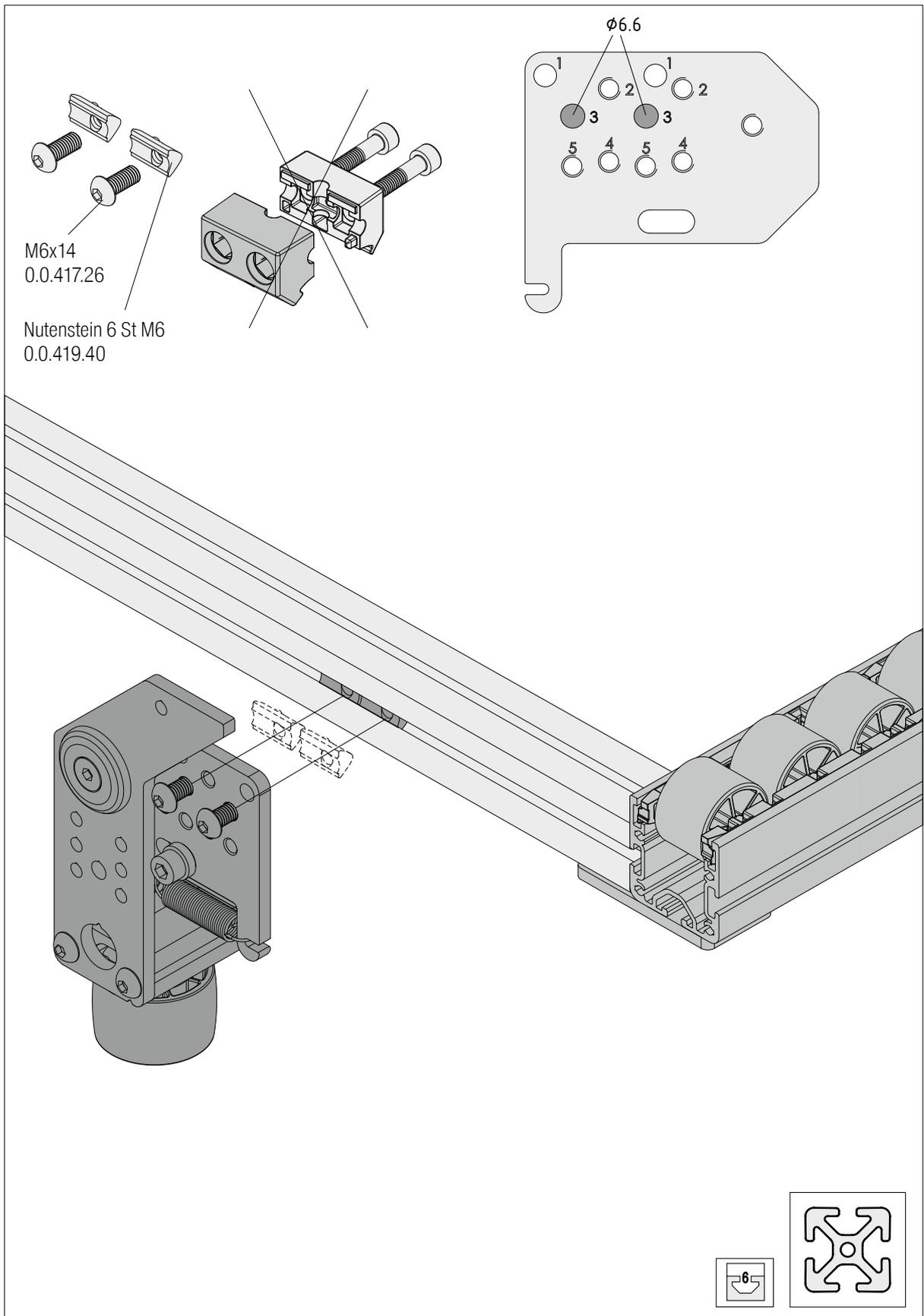
Variante - Transportrollen D30 - Befestigung mit Multiblock D30, Einbaulage unten
