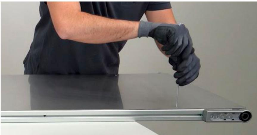
Nach der mittigen Ausrichtung zu den Längsseiten wird das Blech nun noch zu den Umlenkungen ausgerichtet. Der Abstand zwischen der Achse der Umlenkrolle und der Blechkante beträgt 20 mm. Das Blech wird hierzu an die Kante vom Eingriffschutz des Umlenkbeschlags geschoben, sodass nur noch ein kleiner Spalt zwischen Blech und Umlenkrolle bleibt.
