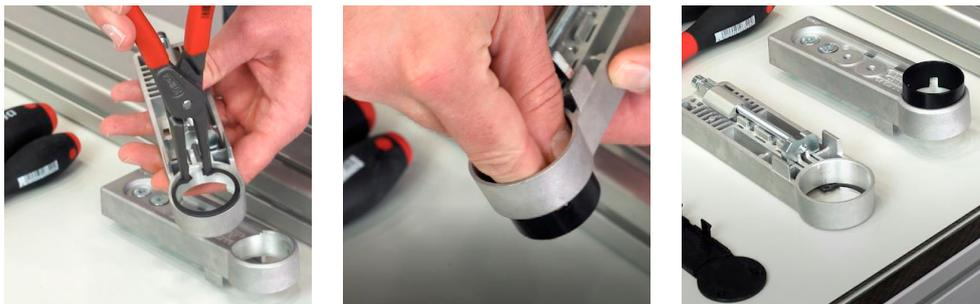
Die Lager der Antriebsrollen werden nun in die Antriebsbeschläge von Hand eingedrückt und anschließend als vormontierter Bausatz seitlich in die Nuten des Profils 8 bis zum Anschlag geschoben und handfest angezogen. Beim Einschieben muss darauf geachtet werden, dass der Zughaken in der Endlage richtig positioniert ist und nicht verdreht oder verklemmt ist. Hierzu dienen die Flachkopfschrauben M8x14.
