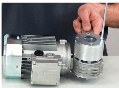
Die Motorachse mit Passfeder wird in einer der Kupplungshälften durch Verschrauben verklemmt und in das Kupplungsgehäuse gesteckt.
