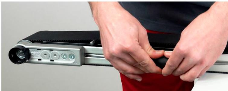
Während des Spannvorganges muss die vorliegende Zahnriemenspannung kontrolliert werden. Hierzu gibt es unterschiedliche Methoden, z.B. mit Hilfe eines Frequenzanalysegerätes oder mit Hilfe eines Stahllineals.
