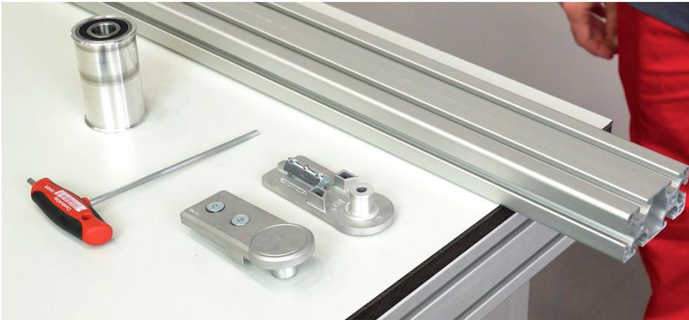
Die Umlenckrolle wird von Hand in die Umlenkungsbeschläge gedrückt bis diese zur Anlage kommt.
