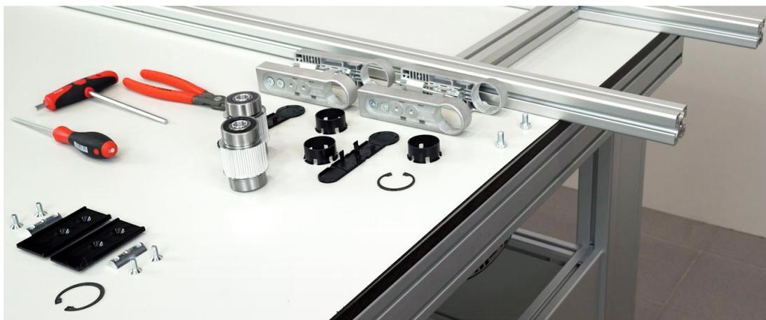
Dazu wird der Wellen-Spannring in den Antriebsbeschlag eingesetzt, welcher dem Motor später gegenüberliegt. Anschließend wird an der späteren Motorseite der Positioniering von innen in der Befestigung durchgeschoben und verrastet.
