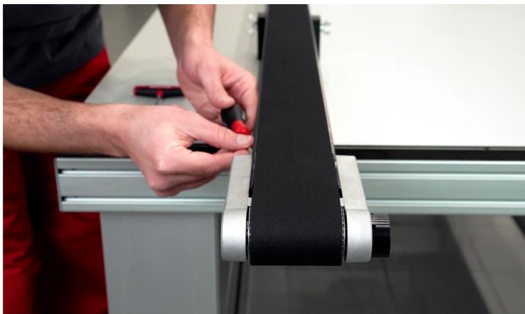
Die Zahnriemen werden so vorgespannt, dass eine prozentuale Dehnung von 0,1% vorliegt. Die Vorspannung wird mit Hilfe der Spannschrauben der Antriebsbeschlägsätze 8 40 innerhalb der Profilnut aufgebracht. Hierbei ist auf ein gleichmäßiges und abwechselndes Anziehen der Spannschrauben zu achten.
