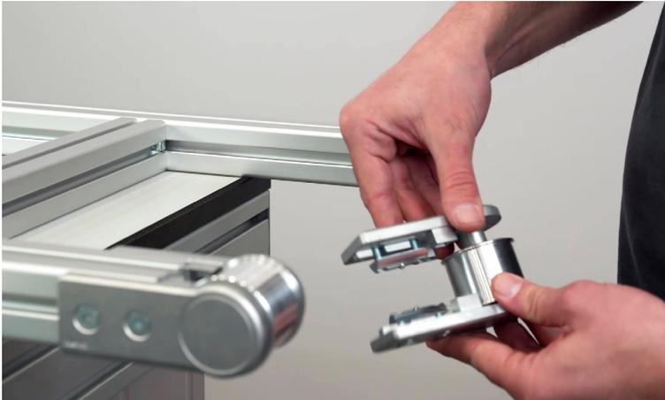
Die Umlenkbeschlagsätze 8 40 werden nach der Vormontage in die seitlichen Nuten des Profils 8 40x40 bzw. des Profils 8 80x40 geschoben und anschließend festgezogen.
