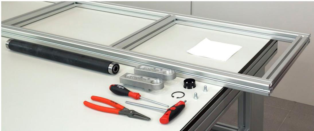
Dazu wird der Wellen-Spannring in den Antriebsbeschlag eingesetzt, welcher dem Motor später gegenüberliegt. Anschließend wird an der Motorseite die Positionierung von innen an der Befestigung durchgeschoben und verrastet.
