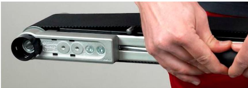
Das Transportband wird durch Drehen der Spansschrauben für eine prozentuale Dehnung von z.B. 0,5% somit auf 5/1000 der gesamten Transportbandlänge gespannt. Im Beispiel mit einer markierten Strecke von 1000 mm liegt die notwendige Vorspannung vor, wenn die Striche um 5 mm auf 1005 mm auseinander gewandert sind. Bei den Transportbändern mit 0,4% bzw. 0,3% prozentualer Dehnung ist die korrekte Vorspannung entsprechend bei einem Abstand der Striche von 1004 mm bzw. 1003 mm erreicht.
