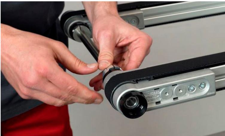
Sitzt das Synchronrohr spielfrei zwischen den Antriebsumlenkungen werden die Kupplungen fest mit dem Synchronrohr verschraubt.
