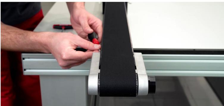
Die Zahnriemen werden so vorgespannt, dass eine prozentuale Dehnung von 0,1% vorliegt. Die Vorspannung wird mit Hilfe der Spannschrauben der Antriebsbeschlagsätze 8 40 innerhalb der Profilvernut aufgebracht. Hierbei ist auf ein gleichmäßiges und abwechselndes Anziehen der Spannschrauben zu achten.
