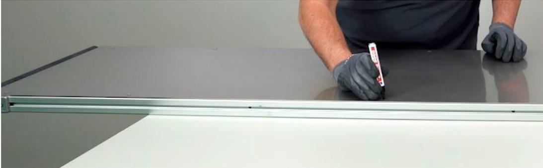
Anschließend wird das Gleitblech wieder entfernt, die Nutensteine platziert, dann wieder aufgelegt und leicht angeschraubt, so dass sich das Blech noch bewegen lässt.
