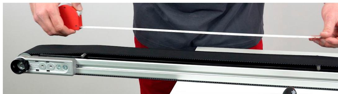
Eine weitere Möglichkeit die Zahnriemenspannung zu kontrollieren erfolgt mit einem Stahllineal. Der Zahnriemen muss hierfür frei liegen und darf nirgends geklemmt sein. Mit Hilfe des Stahllineals wird eine definierte Strecke auf dem Zahnriemen markiert. Hierbei empfiehlt sich z.B. eine Strecke von 1000 mm, da die prozentuale Dehnung von 0,1% einfacher zu kontrollieren und abzulesen ist.
