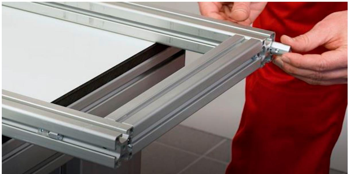
Die Umlenkrolle wird von Hand in die Umlenkungsbeschläge gedrückt bis diese zur Anlage kommt.
