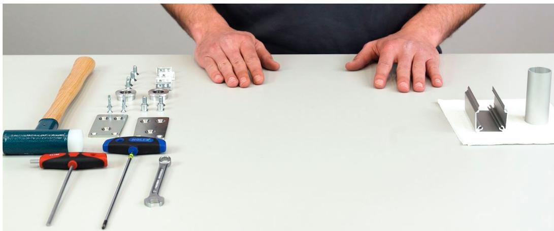
Als erstes wird die Lagerung des Rillenkugellagers an den Laschen montiert. Dazu werden die Laschen mit einer Senkkopfschraube und einer Gewindehülse mit Vierkant, zum Kontern während des Anschraubens, vormontiert.
