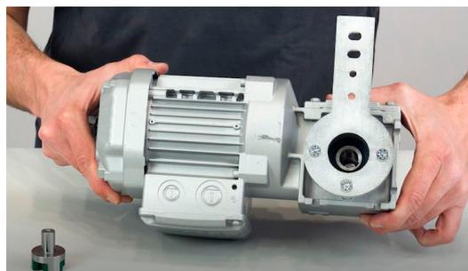
Die Motorachse mit Passfeder wird in einer der Kupplungshälfte durch Verschrauben verklemt und in das Kupplungsgehäuse gesteckt.
