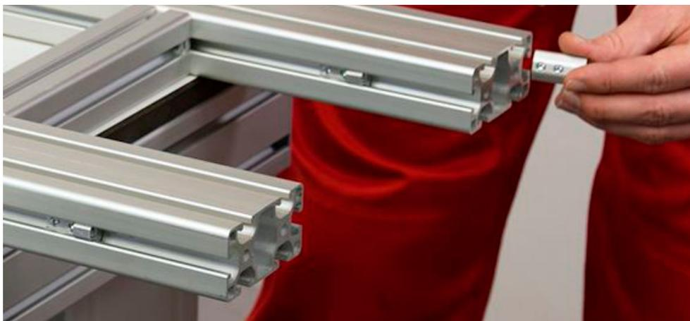
Die Umlenkrolle wird von Hand in die Umlenkungsbeschläge gedrückt bis diese zur Anlage kommt.
