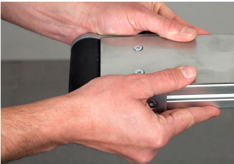
Anschließend werden die Senkschrauben fest angezogen.  $M_A = 5 \text{ Nm}$
