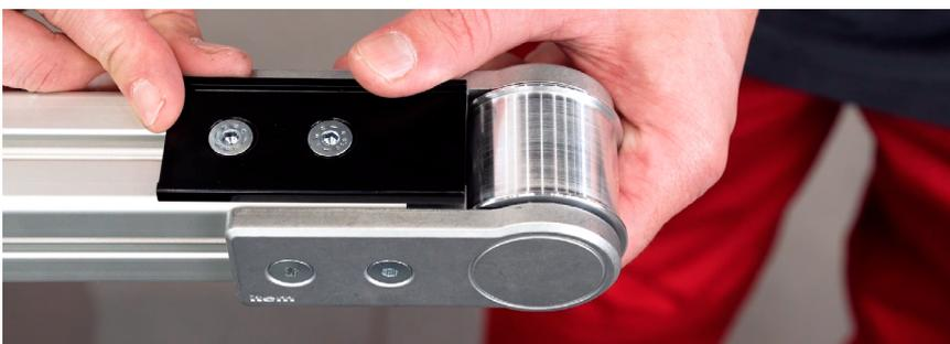
Die Montage der Ein-/Auslauf Führungsleiste an der Antriebsseite erfolgt genauso. Die Endposition ergibt sich hierbei nach der Montage der Führungsleiste im Anschluss an den nächsten Montageschritt.
