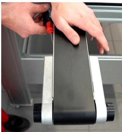
Ist die Vorspannung und der Geradeauslauf justiert werden die Befestigungsschrauben der Antriebsbeschlagsätze 8 40 endgültig festgezogen.  $M_A = 10 \text{ Nm}$
