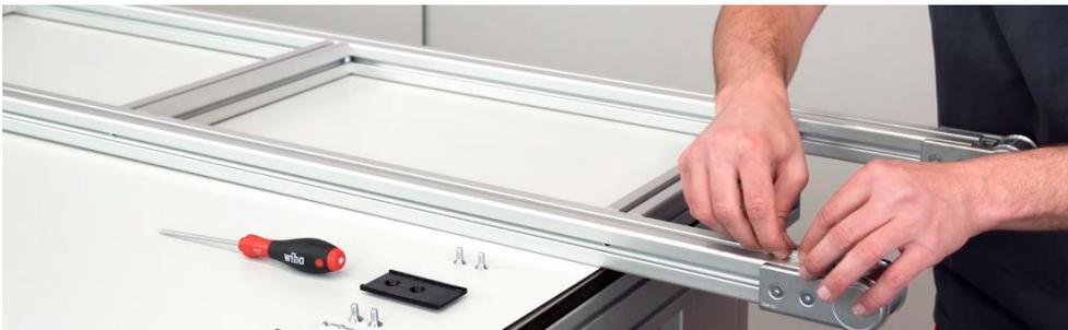
Anschließend wird die Kunststoffplatte leicht angeschraubt, ausgerichtet und bis auf einen Spalt von ca. 2 mm an die Umlenkrolle geschoben. (Abstand Kunststoffkante zur Rotationsachse: 20 mm)
