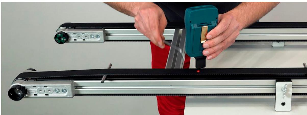
Mit Hilfe des Frequenzanalysegerätes wird die eingestellte Vorspannung über die Frequenz, mit der ein definierter Teilabschnitt des Zahnriemens durch Anschlagen schwingt, ermittelt. Für die notwendige Vorspannung von 0,1% muss bei einem Messabstand von 0,5 m (Abstand der dem Frequenzanalysegerät beiliegenden Zylinderstifte unterhalb des Zahnriemens) eine Frequenz von 50 Hz vorliegen.
