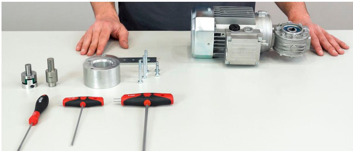
Das Kupplungsgehäuse wird mit der Drehmomentstütze, 3 Zylinderflachkopfschrauben M6 (SW5) auf das Getriebe geschraubt.
