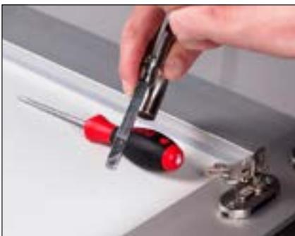
Der Türdrücker wird vorbereitet. Dazu wird der abgestufte Vierkantbolzen bis zur Markierung in die Öffnung des Türdrückers geführt. Der zuvor gelöste Gewindestift wird anschließend festgezogen.
