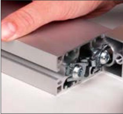
Zuerst wird das Querprofil **7** vorsichtig in die Nut 8 eines vertikalen Türprofils eingeschoben.
