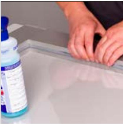
Die obere und untere Fläche werden nun mit den bereits abgelängten Dichtprofilen 8 4-6mm fixiert. Dazu wird zunächst die Klemmstelle (Profil-Fläche) mit einer Seifenlauge benetzt. Anschließend kann das Dichtprofil an den Enden beginnend und zur Mitte hin eingedrückt werden.
