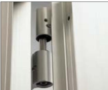
Die nun fast fertige Tür kann zur weiteren Montage in das Rahmenprofil, der Grundkonstruktion, eingehängt werden.
