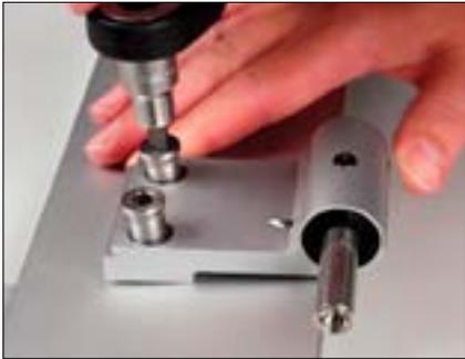
Die beiliegenden selbstfurchenden Innensechskantschrauben werden abwechselnd in die Bohrungen  $\text{Ø}11\text{mm}$  am Türprofil 8 103x40 geschraubt. Der Vorgang wird für das andere Scharnier wiederholt.
