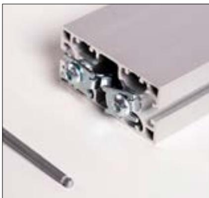
Man beginnt mit den Querprofil **7**. Dieses wird in ermittelter Länge mit vier Gewinden M8x20, je zwei auf beiden Seiten des Profils versehen und mit den einseitigen Standard-Verbindungsätzen bestückt, dabei ist die Ausrichtung des Verbinders entscheidend (Ausrichtung wie im Bild dargestellt), damit die Flächen später kollisionsfrei montiert werden können.
