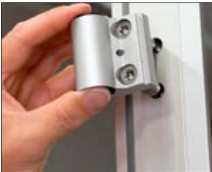
Die zweite, kurze Scharnierhälfte wird nun mit den selbstformenden Innensechskantschrauben im Rahmenprofil der Grundkonstruktion verschraubt. In diesem Fall ein Profil X 8 mit geschlossenen Nuten.
