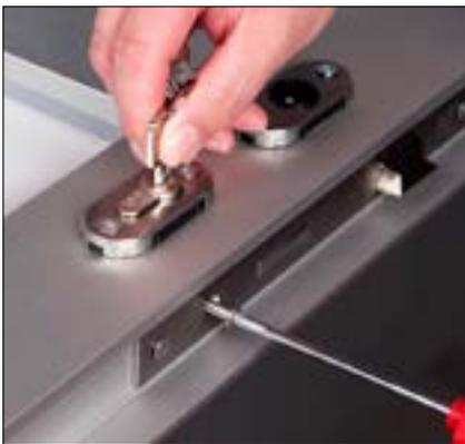
Der Schließzylinder wird in die dafür vorgesehene Aussparung eingeschoben, dazu muss der Schlüssel so gedreht sein, dass die Verriegelungen den Einschub nicht behindern. Mit dem Schraubendreher wird von der Seite die Schraube M5x50 in den Schließzylinder geschraubt und ebenfalls handfest angezogen.
