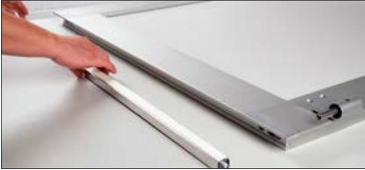
Der beigelegte Klebestreifen wird auf die Rückseite der Absenkdichtung aufbracht. Die Schutzfolie abziehen und am Türprofil in der dafür vorgesehenen Aussparung vermitteln. Der helle Kunststoffstift muss bei der Ausrichtung zur Scharnierseite weisen.
