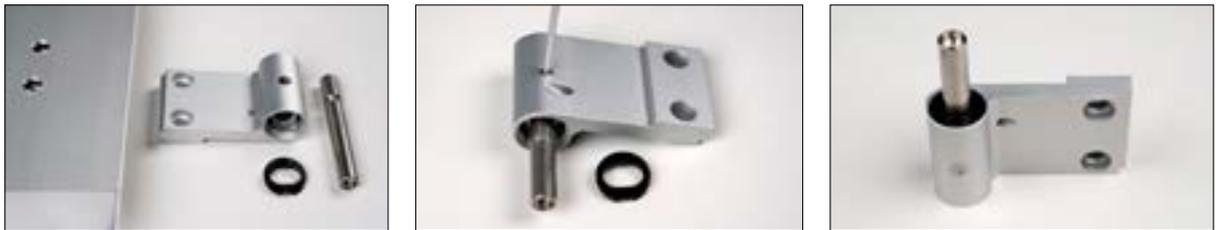
Der Scharnierbolzen wird mit der Freimachung in den Scharnierlappen geschoben und an der Freimachung mit dem am Scharnierlappen befindlichen Innensechskant-Gewindestift (SW3) fixiert.
