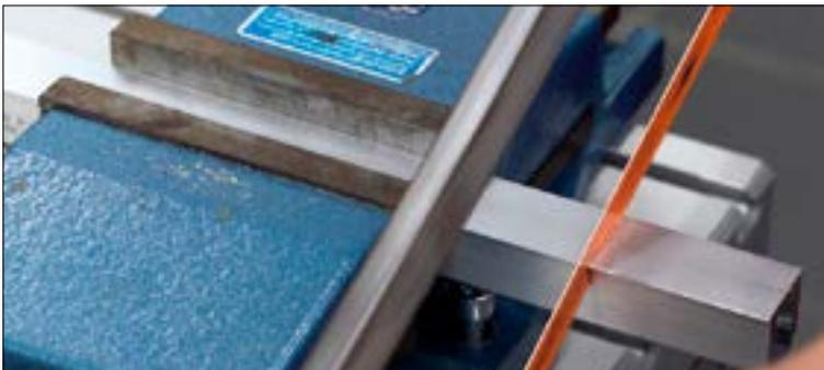
Die Tür-Absenkündigung besteht aus einer gefedert gelagerten Gummidichtung, welche einseitig mit einer handelsüblichen Metalbügelsäge gekürzt werden kann. Der helle Kunststoffstift ist Teil des Absenkmechanismus und darf nicht abgesägt werden.
