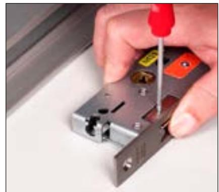
Um den Riegel zu drehen und funktionell anzupassen wird zunächst der Torx Gewindestift TX8 entfernt und der gefederte Riegel entnommen, anschließend wird das Einsteckschloss gedreht und der Riegel auf der anderen Seite des Einsteckschlusses wieder eingesteckt und verschraubt.
