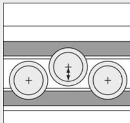
C-Schienensystem 3R mit spielfrei einstellbaren Lagereinheiten. Die 3 kugelgelagerten Stahlrollen laufen auf 2 geschliffenen Wellen und sind für besondere Ansprüche an die Präzision der Führungen geeignet. Diese Variante kann hohe Belastungen in Zugrichtung aufnehmen und läuft besonders reibungsarm.
