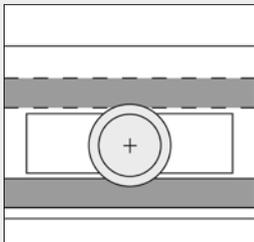
C-Schienensystem 1R auf prismatischen, kugelgelagerten Stahl-Laufrollen und einer geschliffenen Führungswelle. Eine zweite Führungswelle kann zusätzlich montiert werden, um ein Verkippen der Schiebetür beim Betätigen zu begrenzen.
