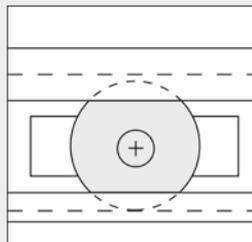
C-Schienensystem K mit Schlitten auf gleitgelagerten Kunststoffrollen, die direkt auf dem Aluminium-Schienenprofil laufen. Diese Variante kann geringe Lasten in Zugrichtung aufnehmen und erfüllt einfache Führungsansprüche.
